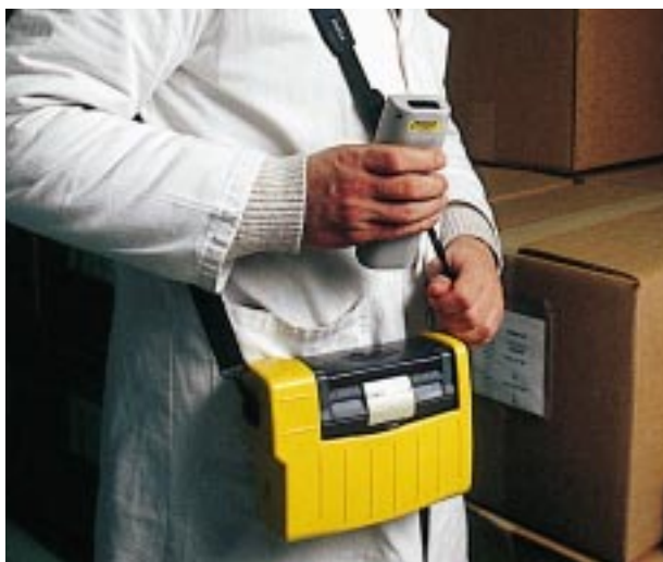
Comunicazione ad infrarossi tramite la porta IrDA integrata
