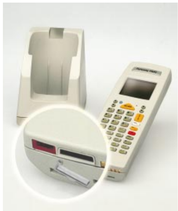
Porta IrDA e seriale completa RS-232 integrate nel F7400 Pro
