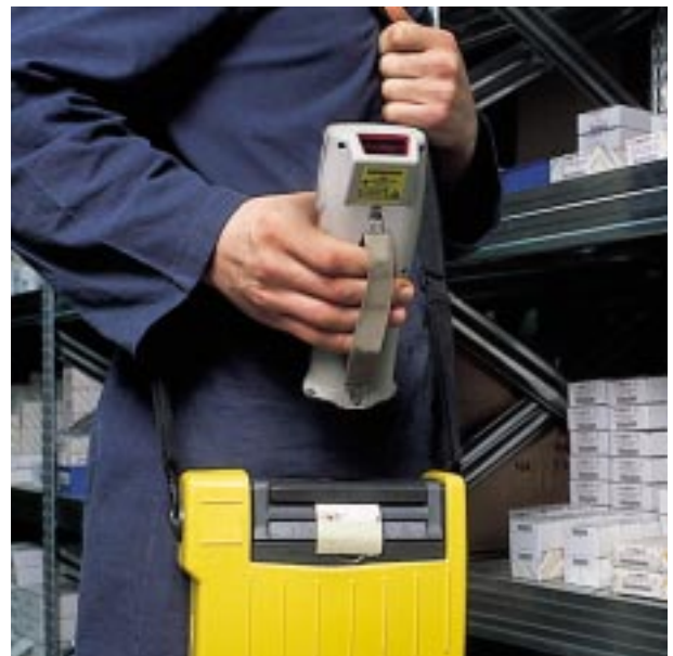
Trasmissione ad infrarossi attraverso la porta IrDA integrata.
